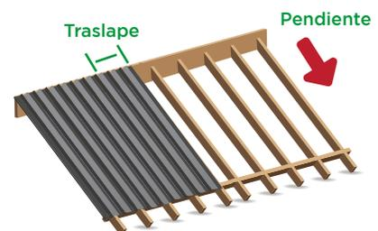
**4. El traslape transversal máximo:** El traslape recomendado es a un canal o traslape simple como se aprecia la imagen de ejemplo. En casos donde se amerite se puede instalar a doble canal siempre que el material no tenga antisifón y que no supere los 20 cm, ya que traslapes de mayor longitud pueden ocasionar la acumulación de agua pluvial y generar un problema de oxidación en esta área.
